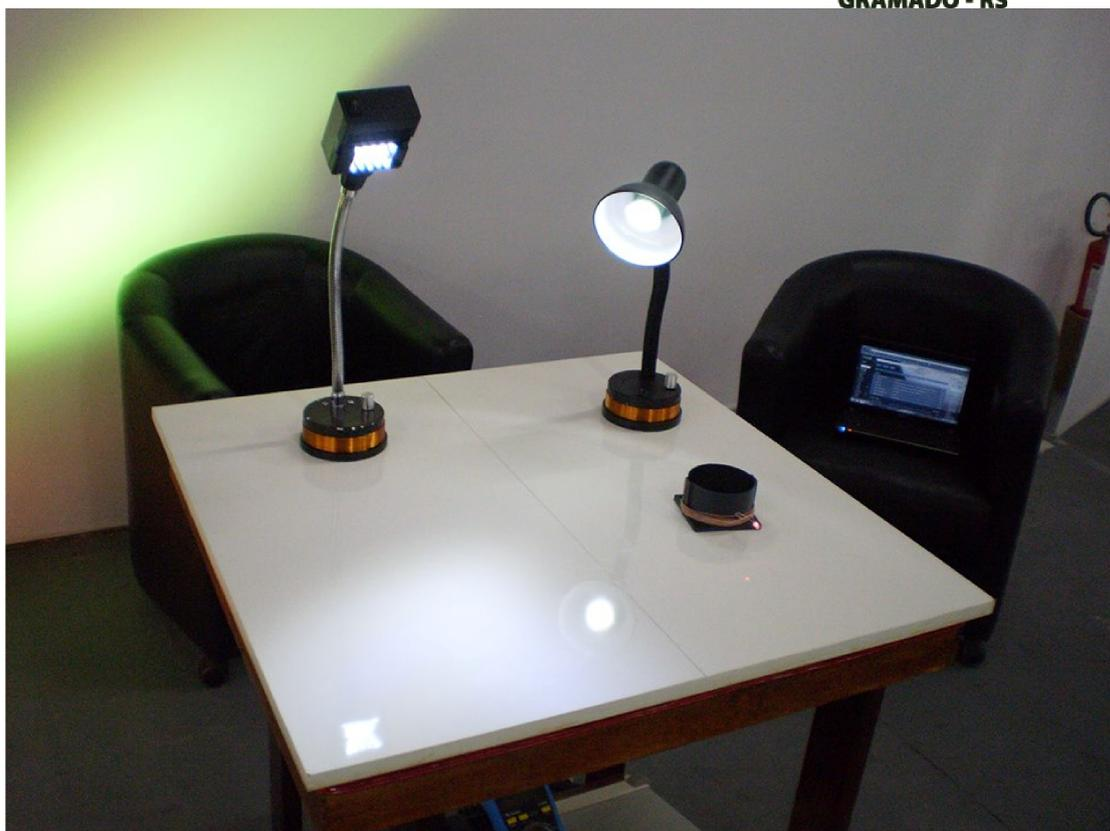
Figura 3 – Módulo de transmissão de energia elétrica sem fio (Fonte: dos autores).
