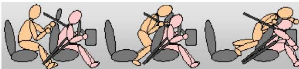
**Figura 1 - Deslocamento do passageiro do banco traseiro em caso de diminuição brusca de velocidade. Fonte: SARAH, 2012**
