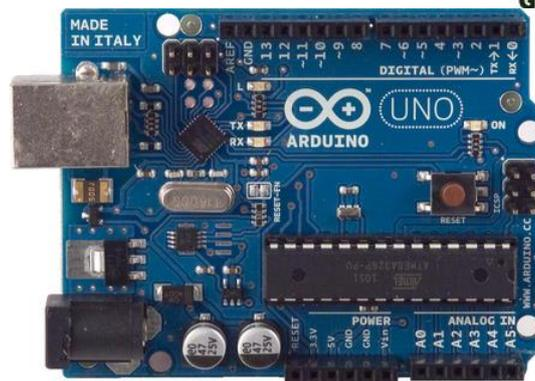
Figura 3 - Plataforma de Desenvolvimento Arduino UNO. Fonte: Arduino, 2013
