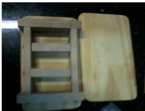
Figura 7 - Molde de madeira para confecção dos núcleos.
