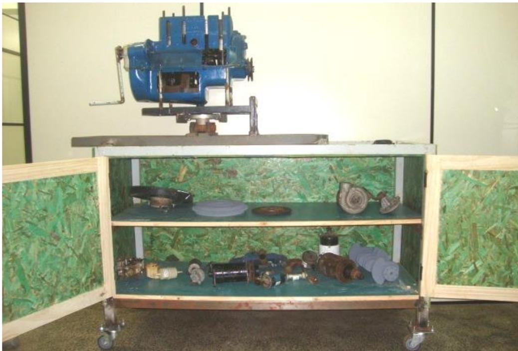
Figura 3 - Bancada didática de motores finalizada.
