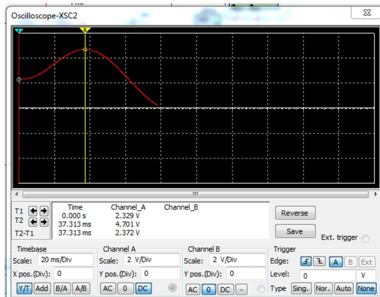
Figura 7 - Sinal obtido da saída do filtro PB.
