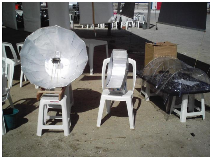
Figura 3 – Concentradores solares: parabolóide e cilíndrico parabólico
