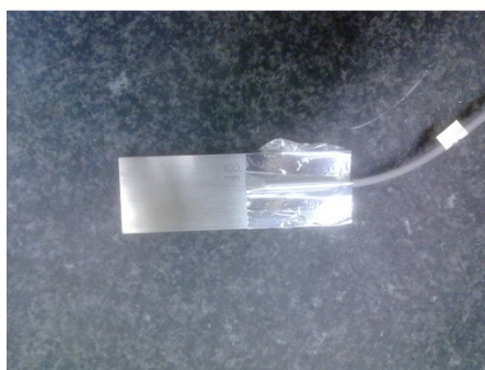
Figura 4 - Bloco de aço na base de granito com o sensor de temperatura
