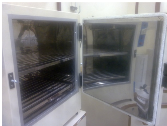
Figura 3 - Forno utilizado para aquecimento controlado do bloco de teste
