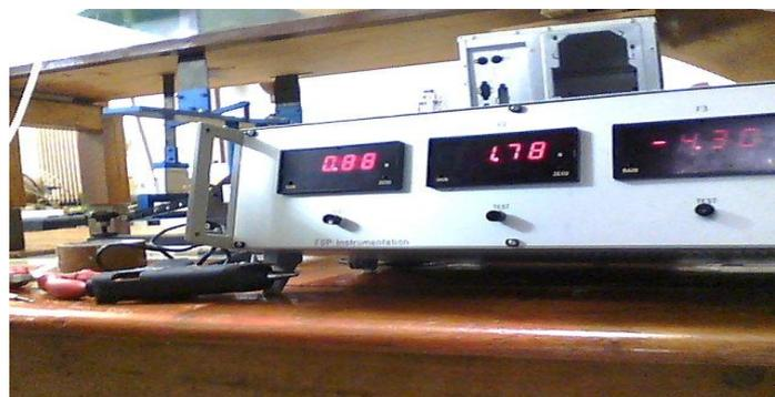
Figura 3- Equipamento que mostra as forças atuantes nos dinamômetros da balança aerodinâmica.
