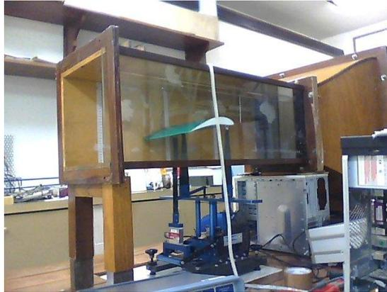
Figura 2- Um perfil aerodinâmico posicionado no túnel de vento
