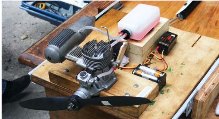
Figura 7 – Bancada para teste de motor e hélice
