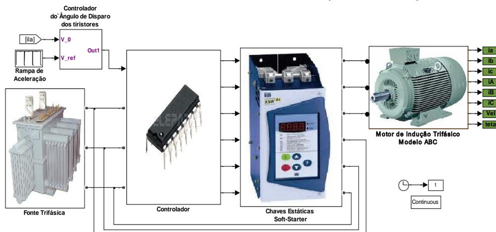
Figura 7 – Modelo Simulink do MIT acionado por sistema de Partida Suave.
