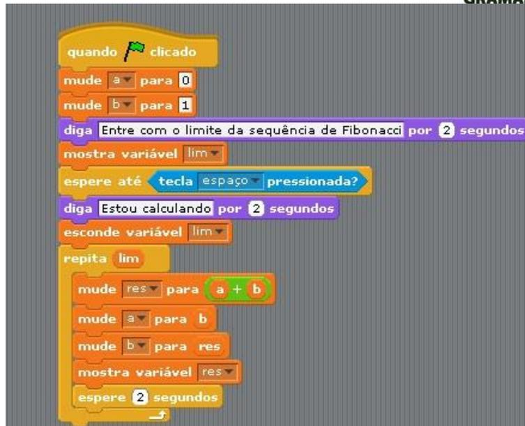
Figura 5 - Algoritmo da sequência de fibonacci executado no Scratch.
