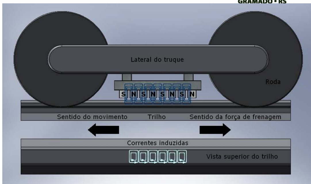
Figura 1: Ação do freio eletromagnético para trens.
