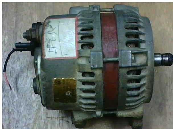
Figura 2: Alternador – GCA 14 V 32 - 55 A (gerador síncrono com saída retificada).
