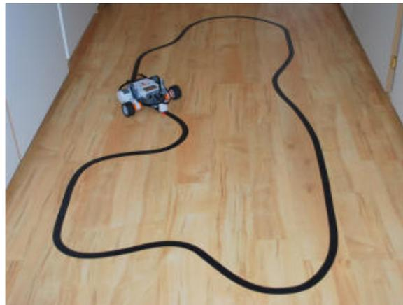
Figura 3: Robô seguidor de trajetória
