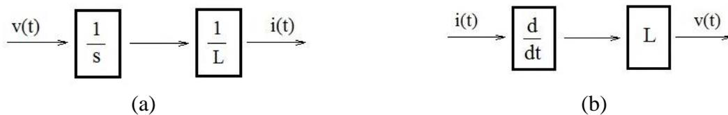
Figura 4: Diagramas de blocos para a indutância, quando a entrada é (a) tensão, e (b) corrente.
