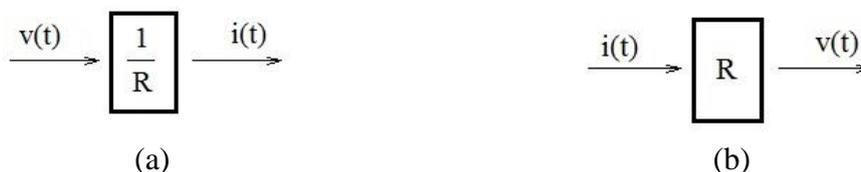
Figura 2: Diagramas de blocos para a resistência, quando a entrada é (a) tensão, e (b) corrente.
