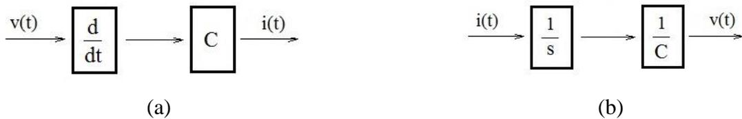
Figura 3: Diagramas de blocos para a capacitância, quando a entrada é (a) tensão, e (b) corrente.
