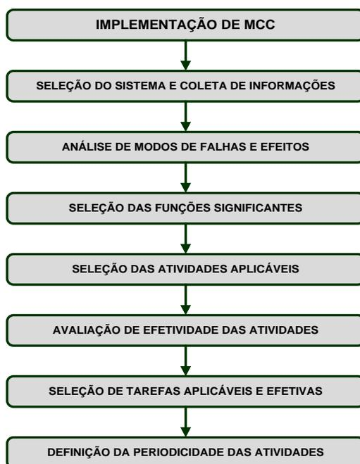
Figura 2 – Procedimentos executados no desenvolvimento da MCC.
