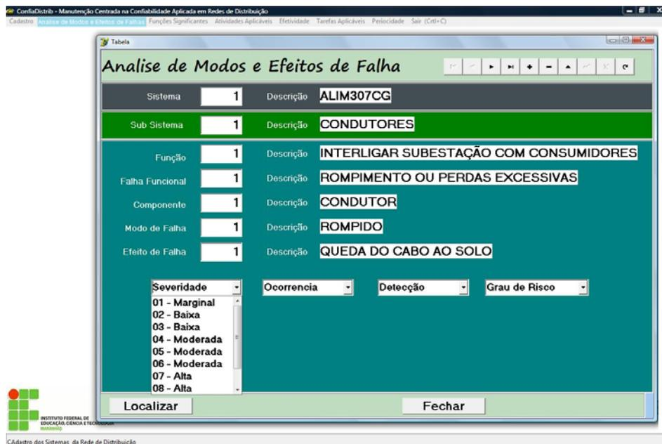
Figura 5 – Tela da Análise de Modos e Efeitos de Falha.
