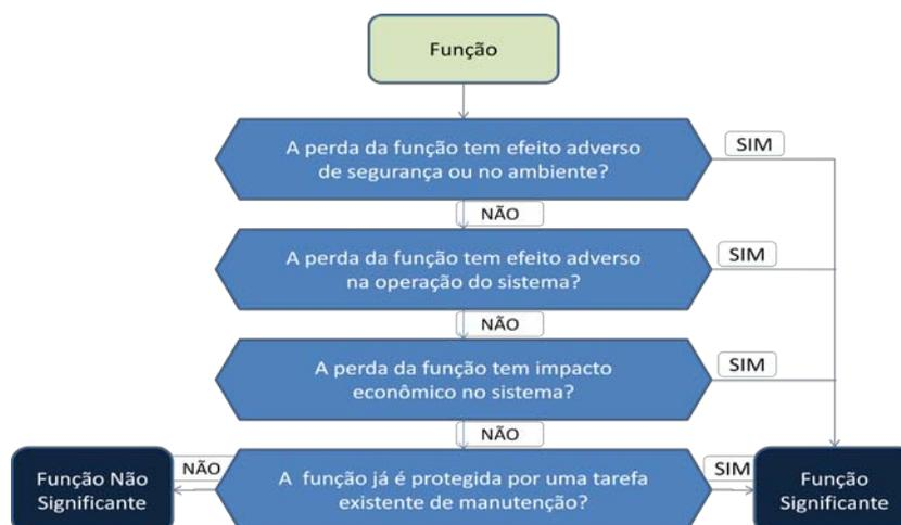
Figura 6 – Diagrama lógico para caracterização da função.
