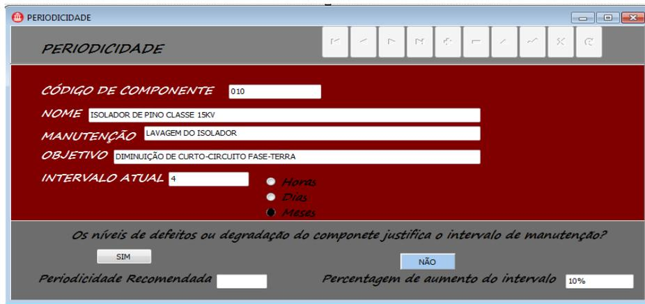
Figura 10 – Definição da periodicidade da manutenção utilizando a exploração de idade.
