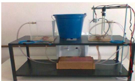
Figura 2. Módulo de Nível e Temperatura
