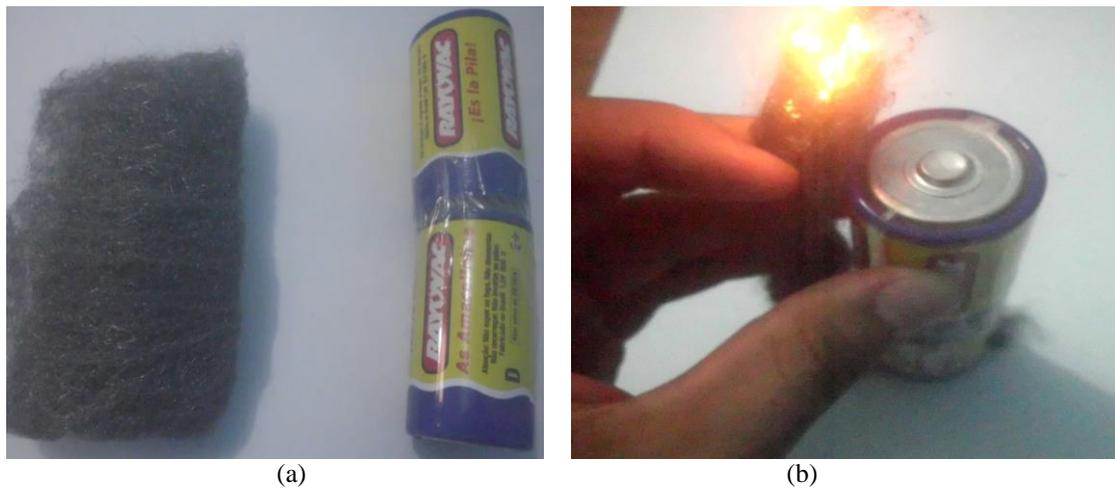
Figura 2 – (a). Materiais utilizados para realização dos experimentos; (b). Esponja de aço em combustão após o contato com a pilha.
