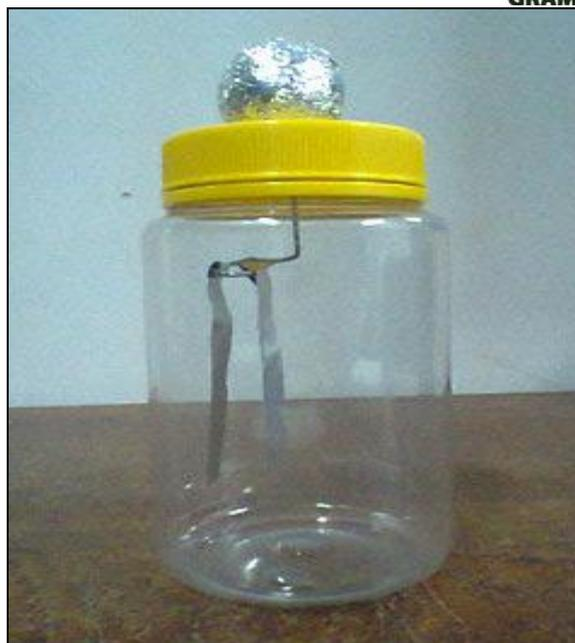
Figura 3. Eletroscópio de Folha.
