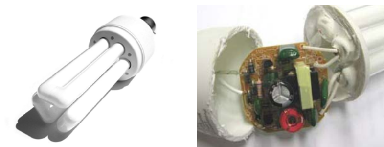
Figura 1 Lâmpada fluorescente e seu circuito eletrônico interno de partida
