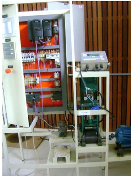
Figura 3 - Bancada da correia transportadora.
