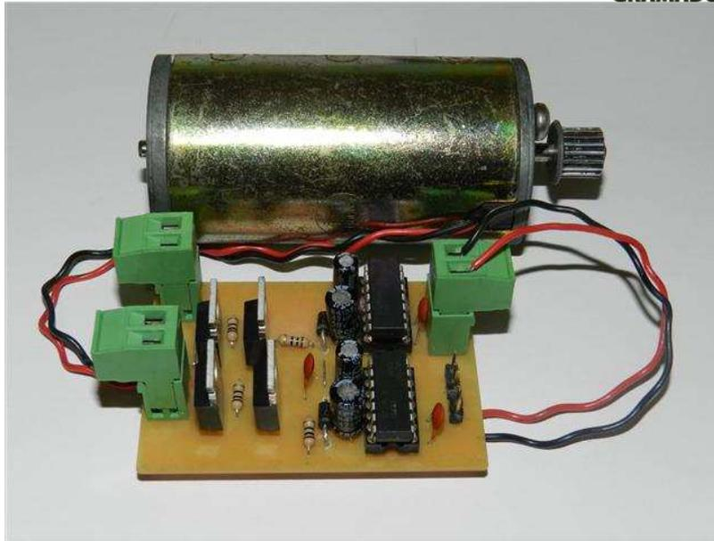
Figura 7 - Protótipo do conversor CC-CC chopper
