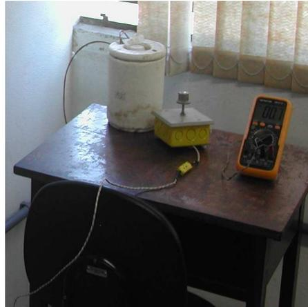
Figura 4 – Termopar ligado ao multímetro e ao bloco de gelo.
