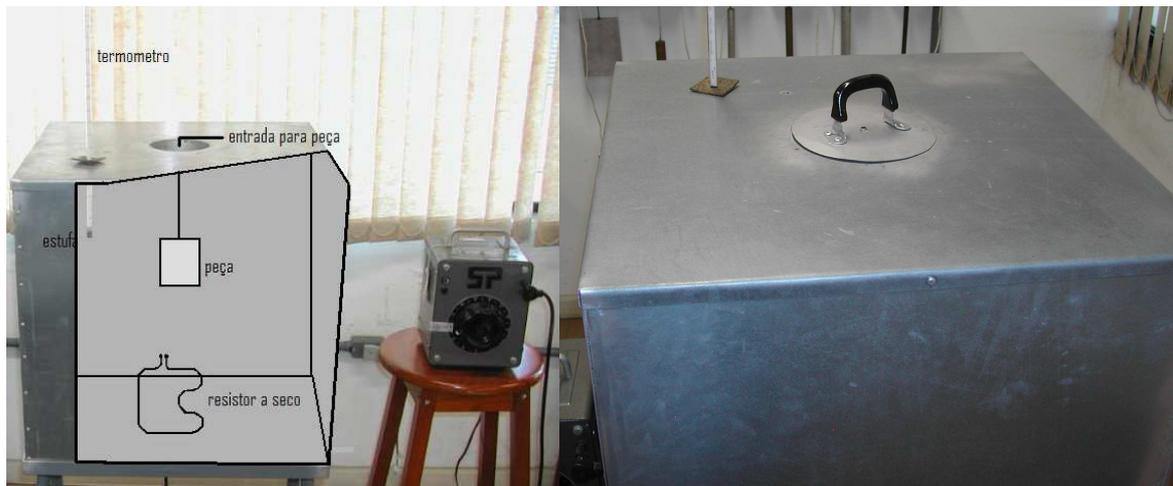
Figura 2 – Esquema e vista de topo da estufa.
