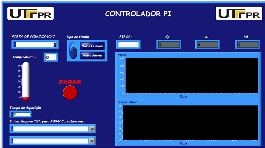
Figura 5 – Interface computacional desenvolvida no LabVIEW®.
