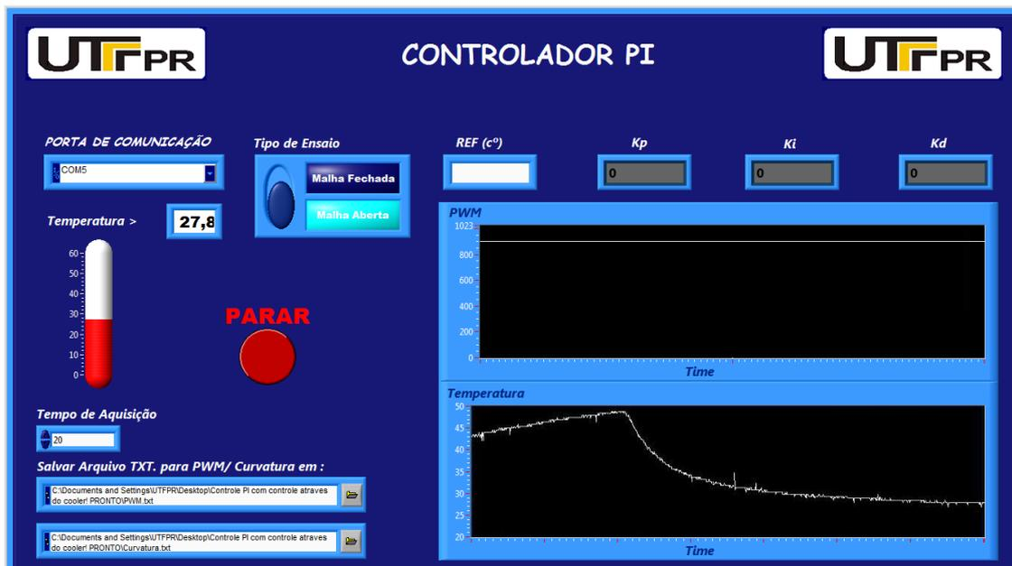
Figura 8 – Tela de supervisão para o ensaio em malha aberta.
