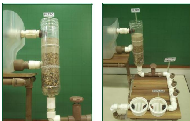
Figura 4: Detalhe do decantador com descarga de fundo. Detalhe do filtro entrada e saída de água. Aplicação de cloro, flúor, correção de pH e chicanas
