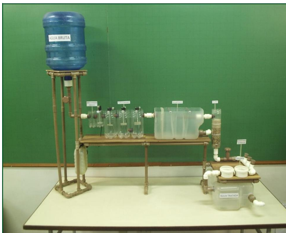
Figura 1: Vista geral do protótipo com todas as etapas do tratamento convencional
