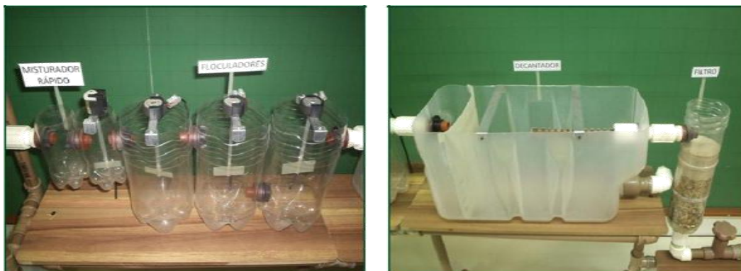
Figura 2: Seqüência de fotos mostrando o misturador rápido, floculador, decantador e filtro.
