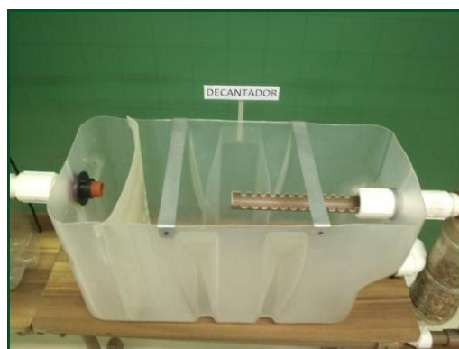
Figura 3: Detalhe do decantador mostrando a cortina de distribuição e canaleta de coleta de água decantada.
