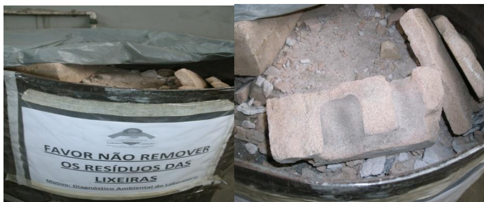
Figura 1: Resíduos de macho (moldes) – areia moldada com a utilização de silicato de sódio ou resina furânica do laboratório de Tecnologia da Fundição, Departamento de Engenharia de Materiais, Centro Federal de Educação Tecnológica de Minas Gerais.
