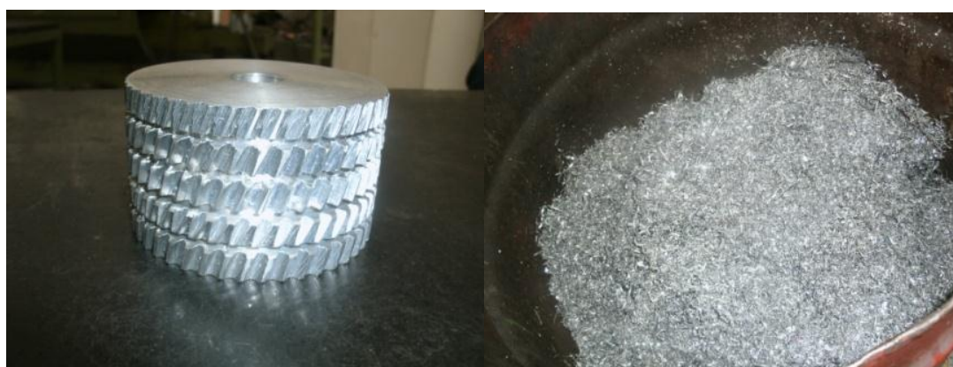
Figura 2 - Engrenagens fabricadas (esquerda) e Limalha de alumínio resultante de uma usinagem computadorizada (direita) do laboratório de Usinagem e Tornearia, Departamento de Engenharia de Materiais, Centro Federal de Educação Tecnológica de Minas Gerais.
