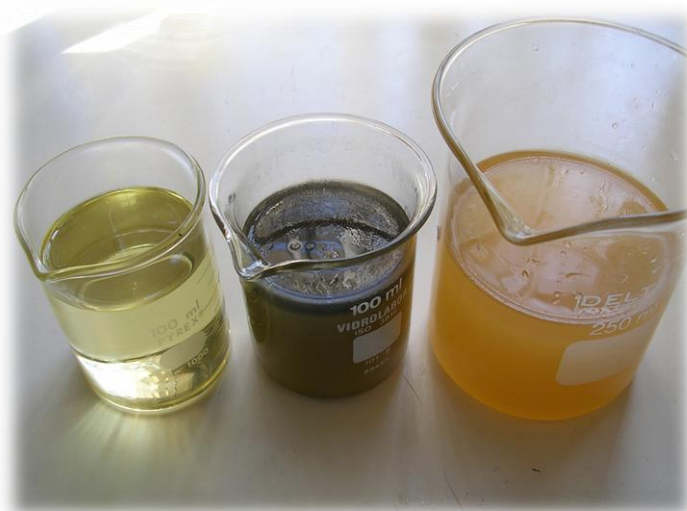
FIGURA 4 – Amostras de óleo cru refinado, óleo de fritura e biodiesel.
