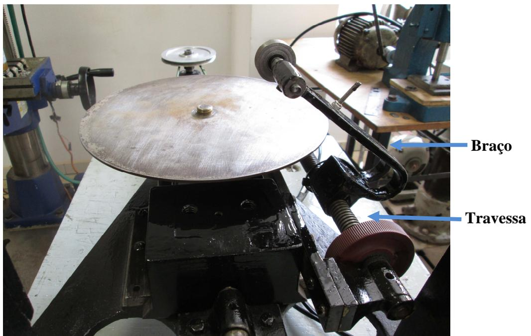
Figura 6. Sistema de fixação dos corpos de prova (pino ou rolo) no tribômetro.
