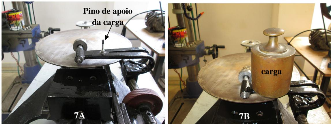
Figura 7. Braço com o pino para apoio da carga (7A) e aplicação da carga (7B).
