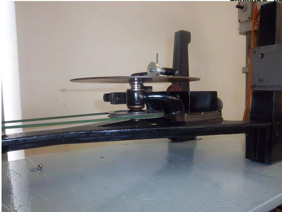
Figura 5. Fixação do disco e sistema de transmissão do tribômetro.
