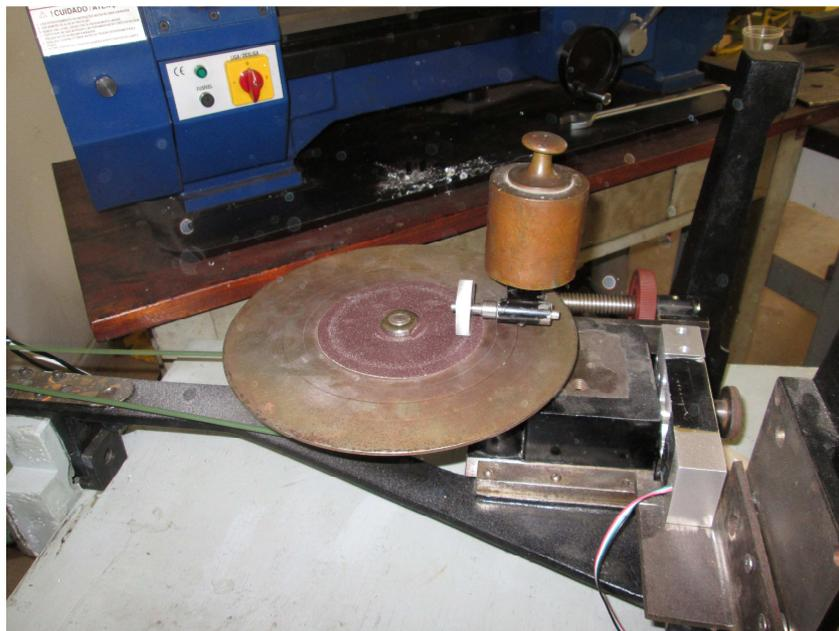
Figura 9. Realização do ensaio de desgaste e testes da máquina.
