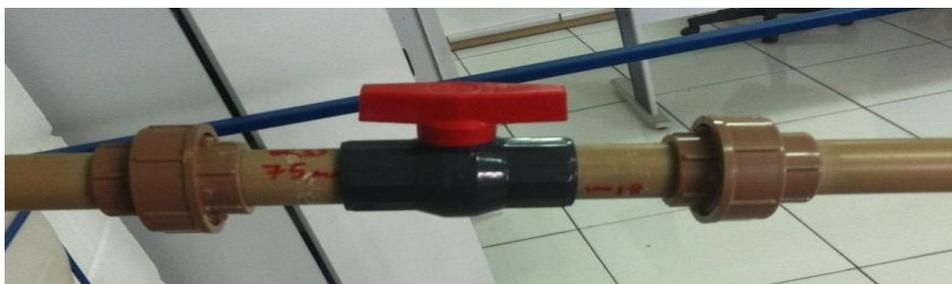
Figura 2 – Seção roscável onde é acoplada a bancada dimensionada.
