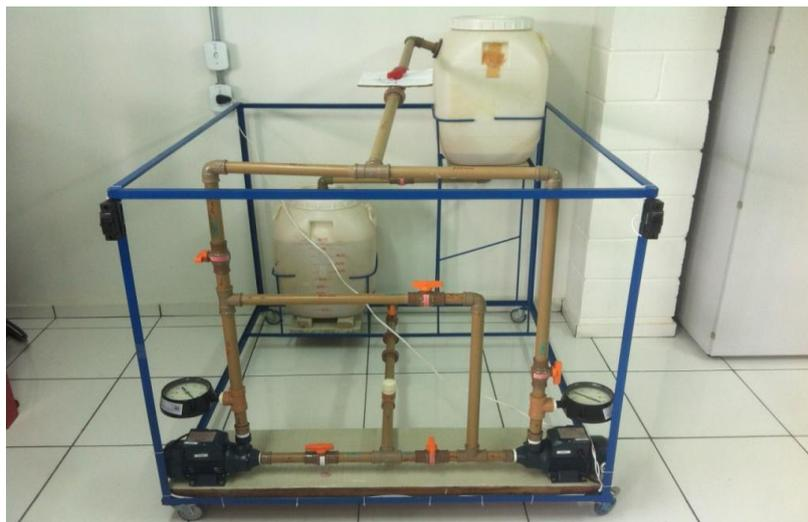
Figura 1 – Vista frontal da bancada para ensaios de bombas
