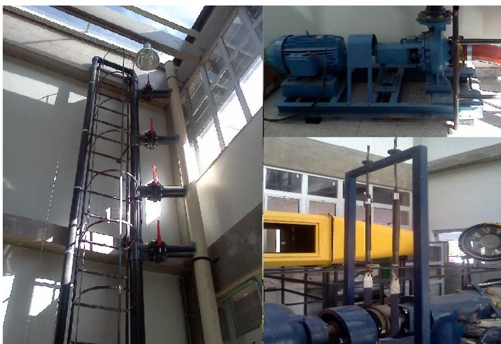
Figura 3 – Fotografias de partes da bancada: elevação com válvulas, conjunto de moto bomba e freio de Prony.
