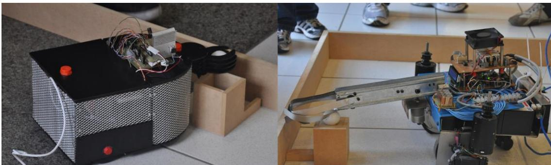
Figura 2 – Exemplos de Robôs desenvolvidos pelas equipes. Nota-se que na imagem A o robô está depositando a bola de *golf* no cesto, enquanto na imagem B o robô está apanhando a bola no suporte.
