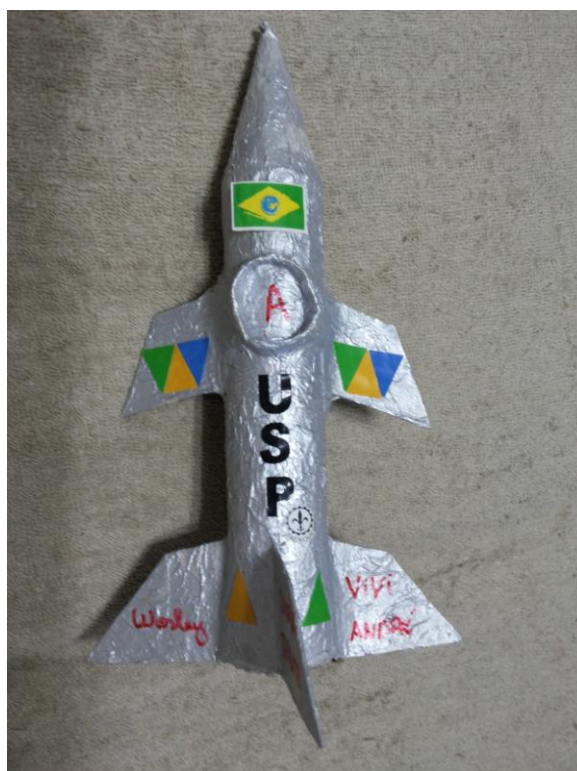
Figura 3: “Foguete” lançado com combustível obtido da eletrólise da água.
