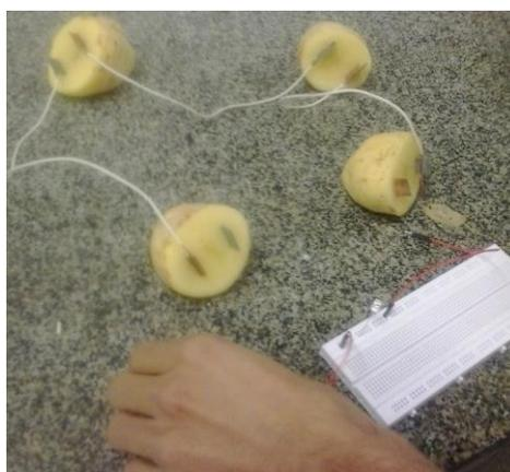
Figura 1- Pilhas desenvolvidas pelos alunos de engenharia elétrica
