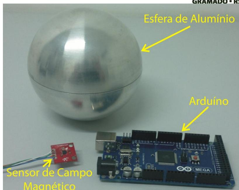
Figura 6 - Fotografia da esfera de alumínio do sensor de campo elétrico, do sensor de campo magnético e da plataforma Arduino utilizados no projeto.
