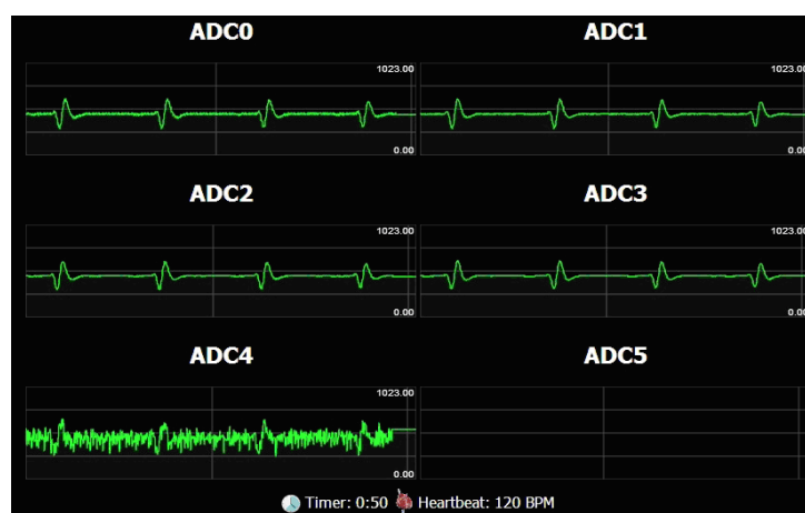
Figura 10 – Visualização na aplicação cliente do sinal de ECG de um voluntário com os eletrodos nas posições V 1 e V 6 .
