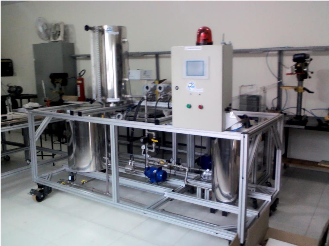
Figura 2 – “Módulo Fieldbus” construído
