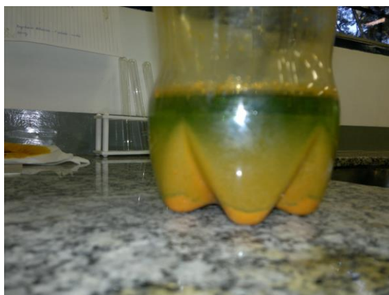
Figura 2: Solução com predomínio de cloreto ferroso, contendo também cloreto férrico e ferrugem.
