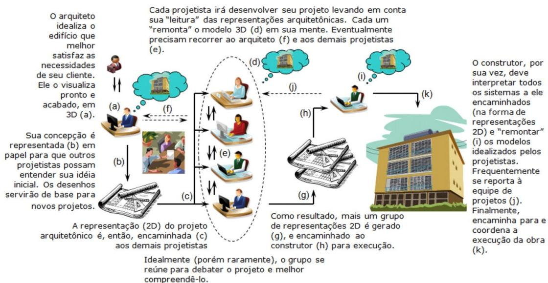
Figura 1 - O fluxo de informações da concepção à construção do edifício (CESAR JR, 2010)
