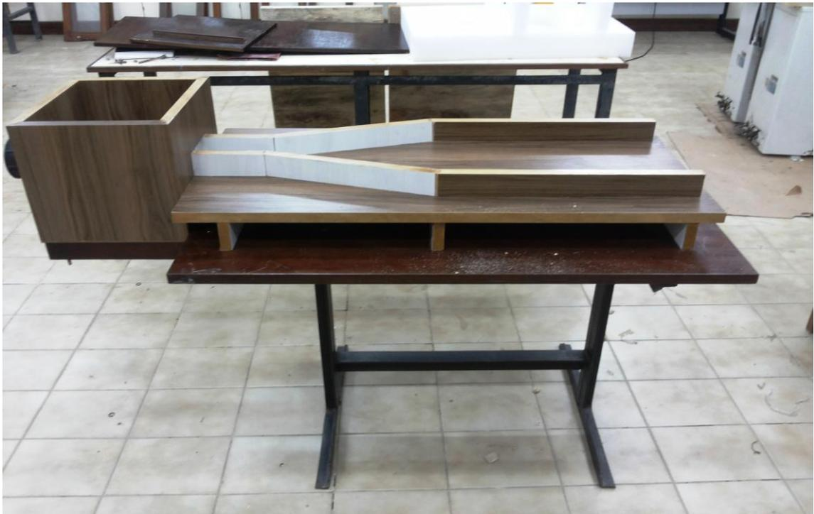
Figura 4 – Túnel de vento experimental sem a tampa de vidro.
