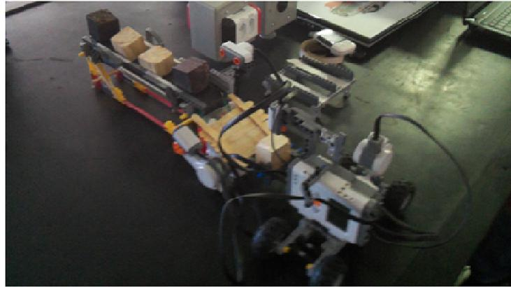
Figura 5 – Projeto Final da Disciplina Engenharia Unificada I – coletor, separador e armazenador de caixas com cores distintas.
