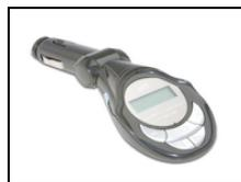
O dispositivo citado anteriormente foi utilizado com um amplificador de RF (radio frequência) acoplado à sua saída de antena para aumentar a distância de alcance de 2m (original) para aproximadamente 100m de raio.
