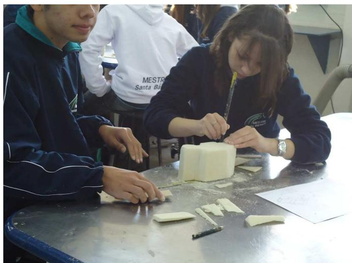
Figura 3 – Modelagem da carenagem no bloco de poliuretano
