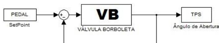
Figura 8 - Circuito de Malha Fechada.
